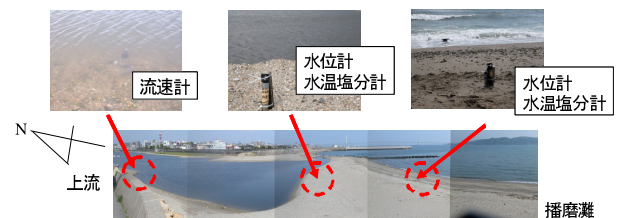
図2 集中調査における計器設置図
