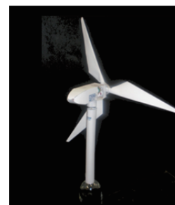
図 6. 水平軸型風車 (ダウンウィンド型)
