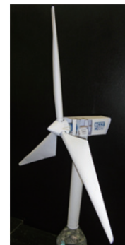
図 5. 水平軸型風車 (アップウィンド型)
