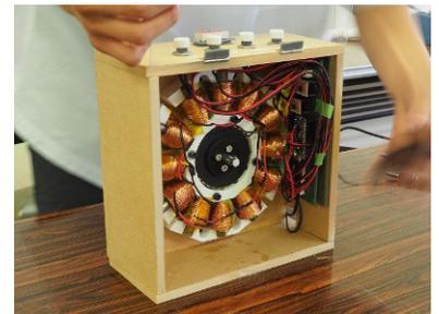
完全自作のステッピングモータ
