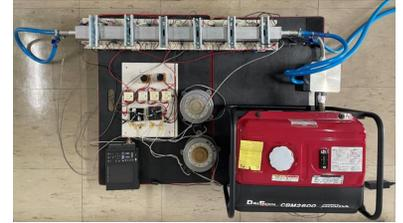
試作器紹介：エンジン発電機の排熱とペルチェ加熱を利用した給湯システム
