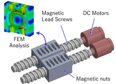
電磁力ねじ駆動アクチュエータ
