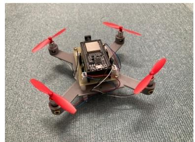
ESP32を用いた小型ドローン
