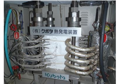
過去に共同開発した焼却余熱利用熱電発電器
