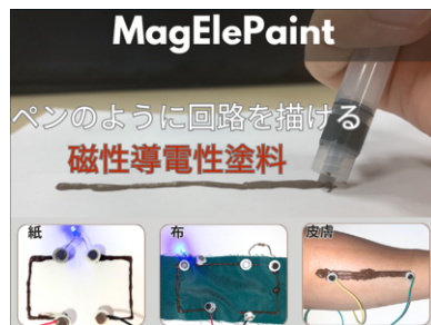
研究例① MagElePaint: 回路試作用の磁性導電性塗料
