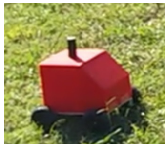
ロボットカーコンテスト(GPS等の信号を受信して自動走行するロボット)
