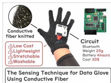
研究例② Grov: 導電繊維を用いた安価かつ多彩なデータグローブ
