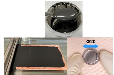
リチウム二次電池作製の様子
