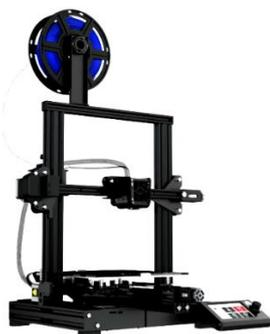
図1 ロボットへの改造の基礎となるGRBL形式のデスクトップ型 3D プリンタの例<sup>(4)</sup>
